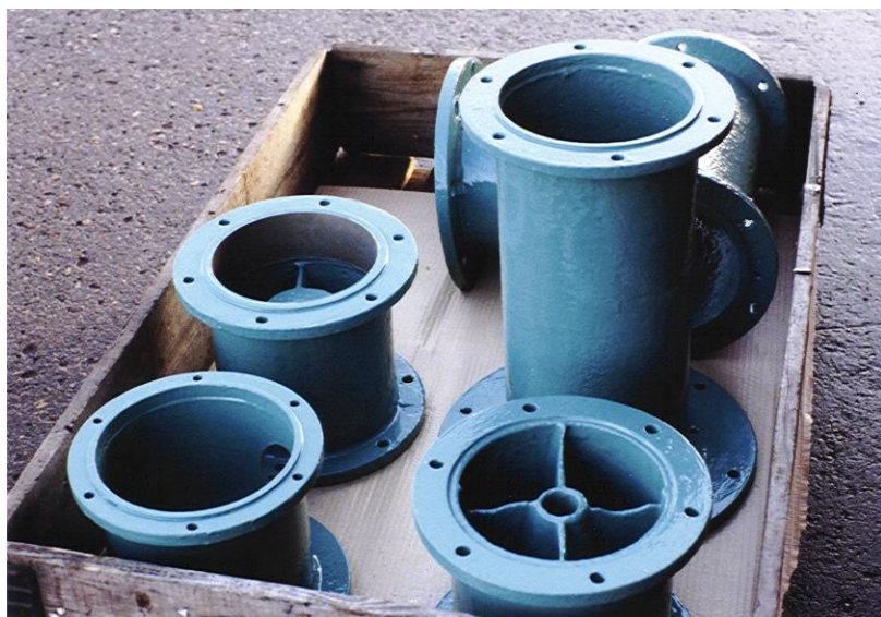
Pumperør sandblæst og malet med 2 lag ARC S2.
